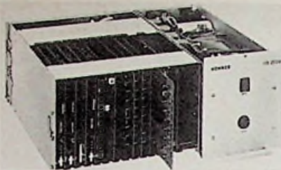
Universeel elektronisch besturingsysteem in inbouwuitvoering. Hiermee kunt u, zonder kennis van de schakellogica, zelf uw besturingsprogramma ontwikkelen en veranderen. Door de vrije programmeerbaarheid is geen verandering van de hardware nodig.
